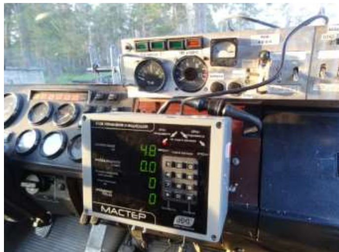
Блок управления АСУР в кабине оператора
